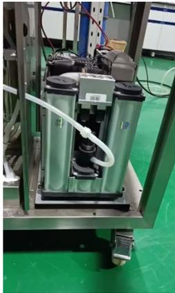
更換方法：將分子篩組件固定螺絲鬆開，組件整體取下，換上新的分子篩。
